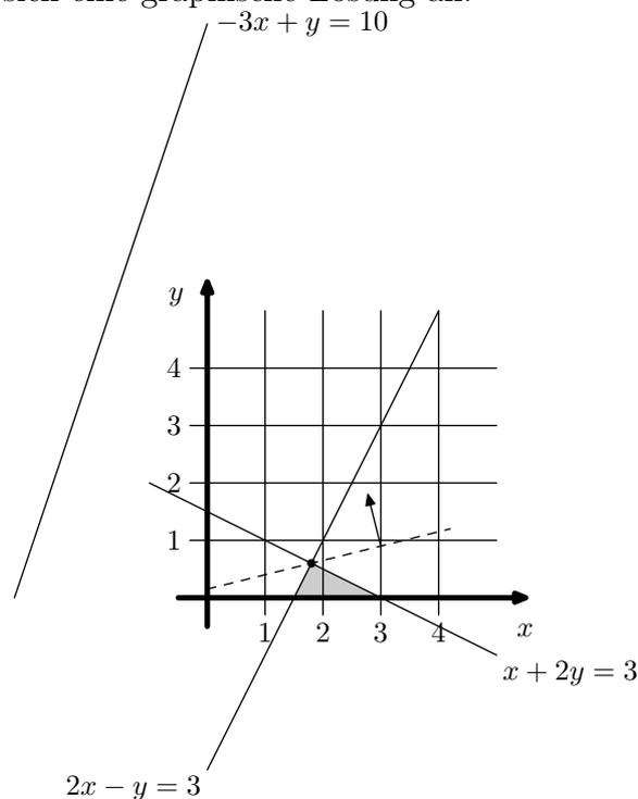
Um den genauen Wert zu finden, müssen wir also entweder alle drei Ecken des Lösungsraums (hier: graues Dreieck) vergleichen oder aber die Zielfunktion so weit verschieben, daß sie auf dem Lösungsraum maximale Werte annimmt. Dies ist oben graphisch durch den Pfeil dargestellt.
